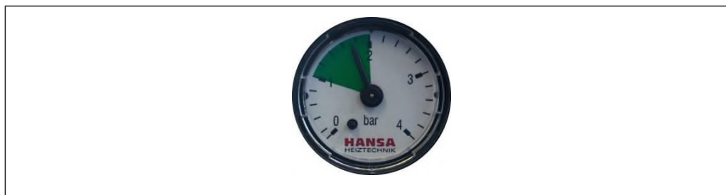
Рис. 12: Оптимальное давление в системе отопления
